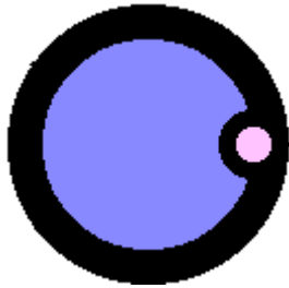
Rysunek 4.27. Symbol wewnętrznego neuronu sieci ( hidden neuron ) z zaznaczonym progiem. Kolor niebieski oznacza stan ujemnego pobudzenia neuronu (hamowanie). Kolor purpurowy wypełniający wnętrze małego wewnętrznego kółka odnosi się do progu neuronu i oznacza jego dodatnią wartość. Jeżeli wnętrze progu byłoby wypełnione kolorem błękitnym, oznaczałoby to jego wartość ujemną.
