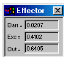
Rysunek 4.42. Okienko dynamicznego podglądu stanu pobudzenia neuronu jego wartości wyjściowej oraz wartości progu, otwierane przez naciśnięcie prawego przycisku myszki, gdy jej wskaźnik znajduje się nad wybranym neuronem.
