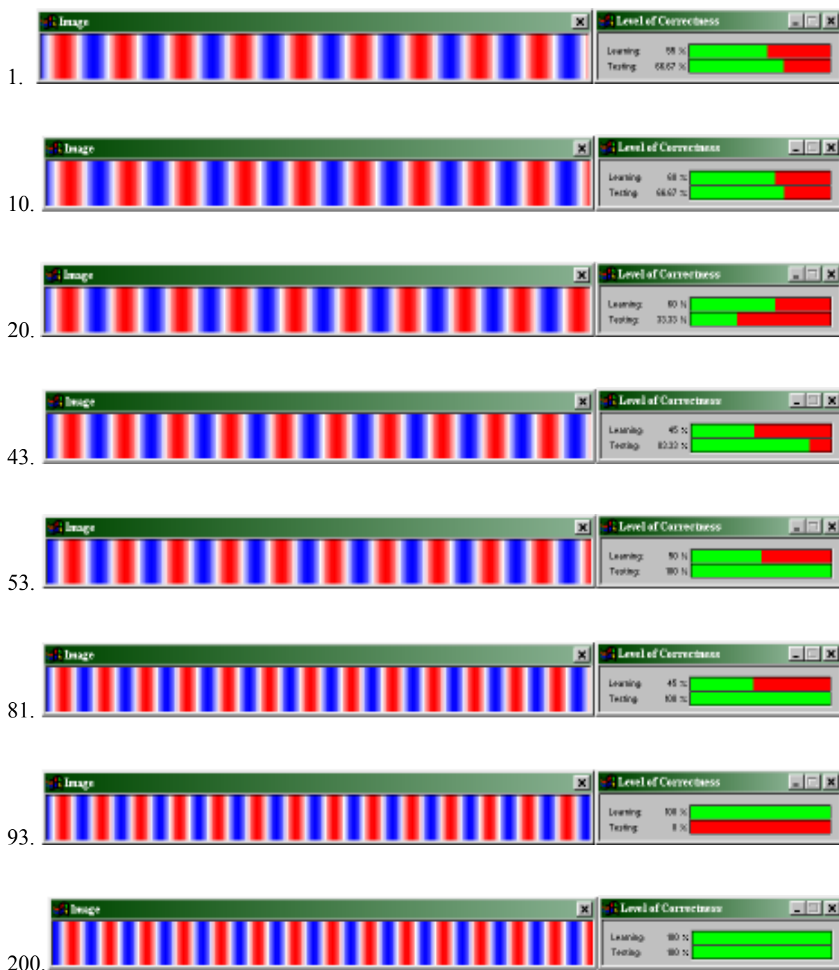
Rysunek 5.10. Na rysunku można zaobserwować proces przesuwania i zagęszczania się kolorowych paseczków (czerwone odpowiadają liczbom parzystym, niebieskie liczbom nieparzystym) związany z procesem formowania się parametrów sieci w procesie jej uczenia się dla przykładu z rysunku 5.9. Dla uzupełnienia z lewej strony obrazów podano odpowiadającą epokę uczącą, zaś z lewej procent poprawności klasyfikacji liczb parzystych i nieparzystych odpowiednio dla wzorców uczących i testujących.
