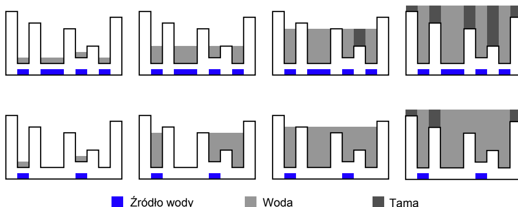
Rysunek 3.3: Idea działania metody wododziałowej, przypadek 1D; Pierwszy wiersz: Zalewanie z minimów w obrazie; Drugi wiersz: Zalewanie z markerów; W kolumnach: kolejne etapy zalewania; Wysokość odpowiada intensywności pikseli w obrazie
