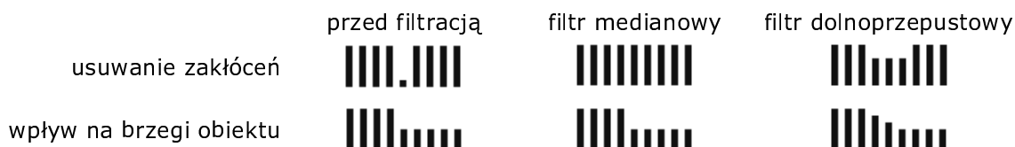
Rysunek 8. Porównanie wpływu filtru medianowego i dolnoprzepustowego na pojedyncze zakłócenia oraz na krawędzie obiektów (na przykładzie jednowymiarowego sygnału).
