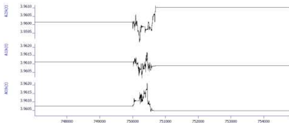
Rys. 5.22. Efekt wymuszonego zaburzenia stanu agentów w systemie trójagentowym w stanie synchronizacji. Przedstawiono wartości współczynnika c w iteracjach poprzedzających i następujących po zaburzeniu.
